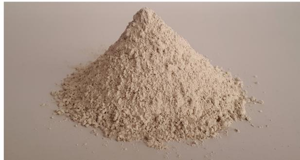
ملاط های نسوز جهت اتصال آجرها در ساخت لایه های نسوز مورد استفاده قرار می گیرند. شرکت صنایع دیرگداز آمل انواع مختلفی از ملاط های نسوز را بر حسب دمای کارکرد و محتوای آلومینا تولید می کند. ملاط های خشک با انواع سیستم های گیرش در هوا و گیرش حرارتی و بر پایه ترکیبات آلومینوسیلیکاتی توسعه یافته اند. ملاط های خشک در سیستم دو جزئی شامل چسب مایع و پودر خشک عرضه می گرددند.
